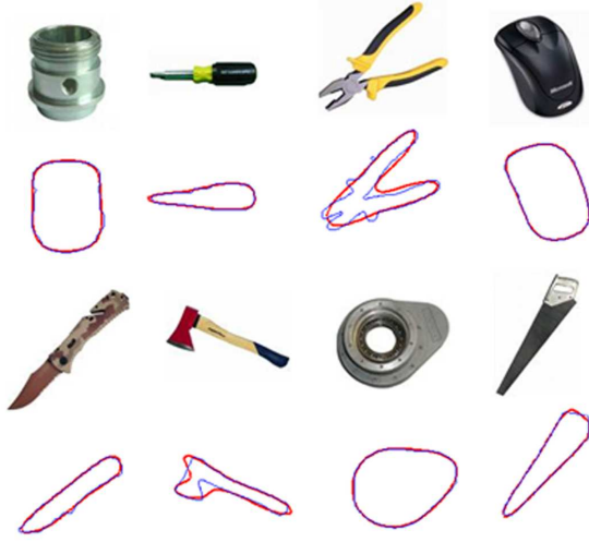
Şekil 1: Bazı örnek şekiller ve bu şekillerin eğri oturtma algoritması [7] ile elde edilen dış hat eğrileri.
