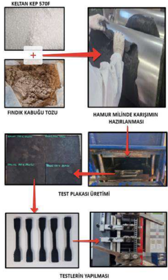
Şekil 2. Numune hazırlamadan karakterizasyona kadar olan süreçlerin şematik gösterimi
