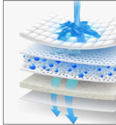
Şekil 3: Bebek bezi katmanlarının geçirgenlik şeması.
