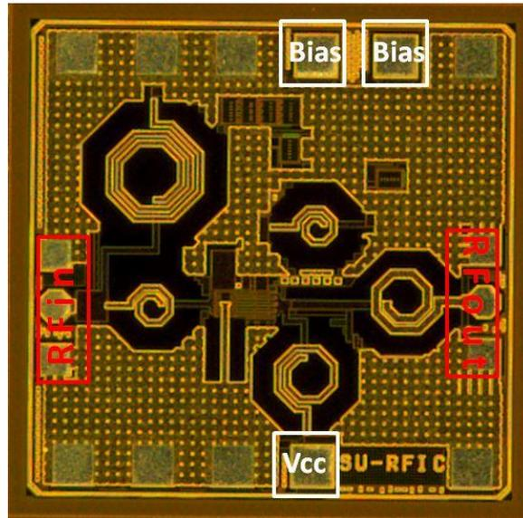
Fig. 19. Die image of Telescopic LNA
