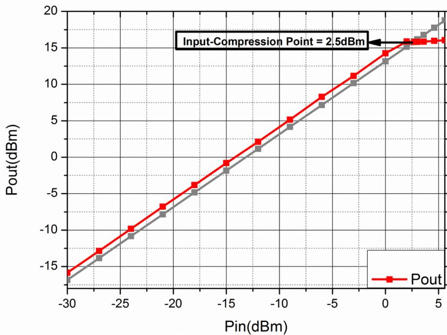
Fig. 23. Measured input-P1dB of Telescopic LNA
