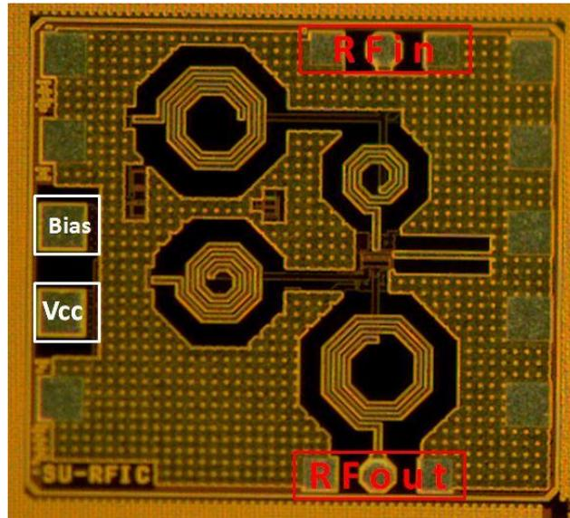
Fig. 11. Die image of Single-Stage LNA
